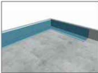
**Polyfleece SX<sup>®</sup> 1000** wird entsprechend der Randschalungshöhe konfektioniert und umlaufend als Streifen mechanisch an der Randschalung befestigt. Der Überlappungsstreifen in der Horizontalen sollte mindestens 10,0 cm betragen.
