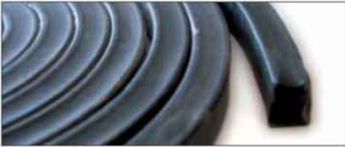
**Bentoproof Black** ist ein ausgereiftes und bauaufsichtlich geprüftes Quellband auf Natrium-Bentonit-Basis zur Abdichtung von Arbeitsfugen im Betonbau. Das Material verändert bei Berührung mit Wasser seine feste Struktur zu einer plastischen Masse, welche in feinste Risse und Hohlräume eindringt. Auch im Bereich von Wasserwechselzonen, d.h. abwechselnd nass und trocken, behält **Bentoproof Black** seine volle Funktionsfähigkeit.
