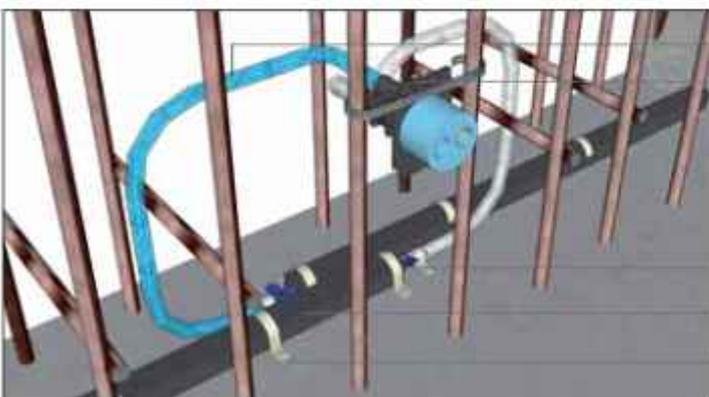
Die Entlüftungsenden werden im **Varioclix\***, welcher an der Bewehrung befestigt wird, zusammengeführt.
