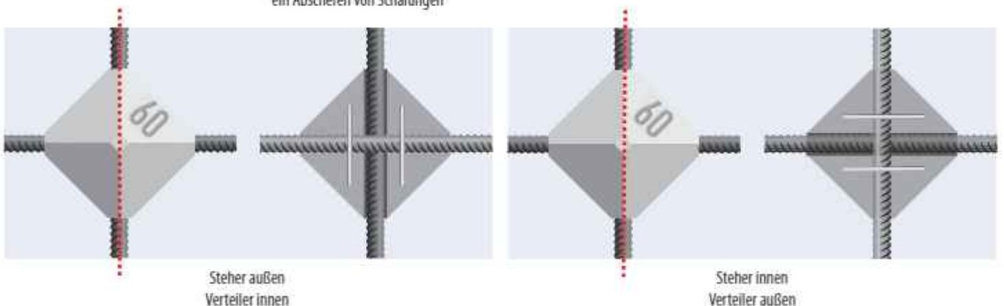
Bei beiden Montagemöglichkeiten bleibt der Kantenverlauf der Pyramidenform immer gleich. Somit ist eine hervorragende Umläufigkeit des Betons garantiert. Durch die optimale Formgebung werden Lunkerbildung, Ansammlungen von Fasern und Luft einschüsse unter dem Abstandhalter ausgeschlossen.
