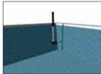
Mechanische Befestigung des konfektionierten **Polyfleece SX<sup>®</sup> 1000**-Randstreifens an der Randschalung
