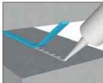
Bei Wasserkontakt wird ein Quellvermögen von bis zu ca. 400 Vol. % erreicht. Durch den linear ansteigenden Quelldruck wird die abdichtende Wirkung erzielt. Insbesondere eignet sich **PolyproofX® 1** auch für die Abdichtung von Dehnungsfugen.
