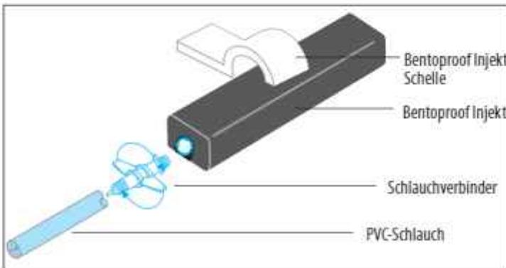
**Bentoproof Injekt PLUS** ist die Zusammenführung zweier aktiver Fugenabdichtungssysteme. Es besteht aus dem bauaufsichtlich geprüften Injektionsschlauch **WaterproofX 1** und dem ebenfalls bauaufsichtlich geprüften **Bentonit-Quellband Bentoproof black/Bentoproof black PLUS**.
