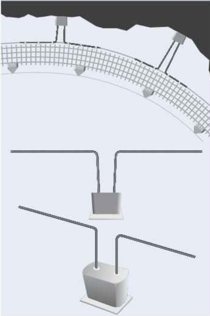
Sonderabstandhalter mit 2 Einsteckhülsen mit Rückverankerung. Dieser Abstandhalter dient dazu, die Bewehrung bei bergmännisch aufgefahrenen Tunneln im Ulmenbereich gegen den Abdichtungsträger in der benötigten Distanz abzustützen. Der Abstandhalter besitzt stark gerundete Kanten und kann auf Wunsch mit einem 1000 er Schutzvlies versehen werden um eine evtl. vorhandene Abdichtung nicht zu beschädigen.
