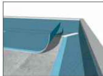
70mm Überlappungsbereich mit vorkonfektioniertem **Polyfleece SX<sup>®</sup> 1000**-Klebeband
