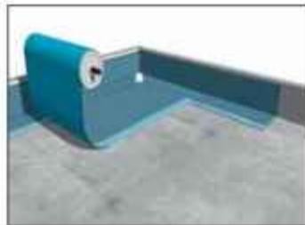
In der Horizontalen Anschluss der 1,0 x 20,0m-Bahnen an Überlappungsstreifen des vorher an die Randschalung angebrachten **Polyfleece SX<sup>®</sup> 1000**-Streifens
