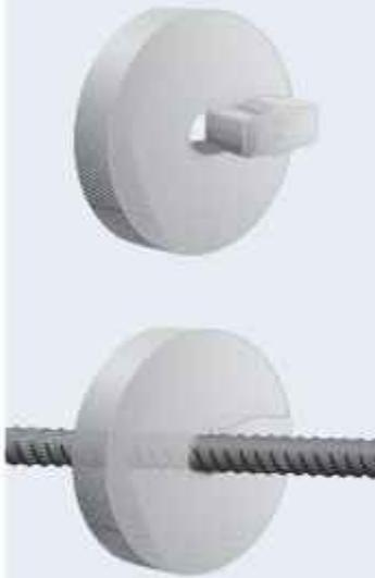
• Der neu entwickelte Sonderabstandhalter „Rolle“ von **BAG® Bauartikel GmbH**, mit Nut und Verschlusskeil, wird einfach auf das vorhandene Verteilereisen aufgesteckt und durch den mitgelieferten Betonkeil verschlossen.
