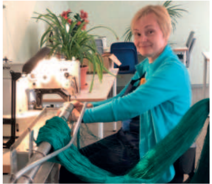
Genmontering på brugte liner op til Ø 25 mm og 3 str. reb op til Ø 14 mm. / Remounting of old topline up to Ø 25 mm and 3 str. ropes up to Ø 14 mm.
