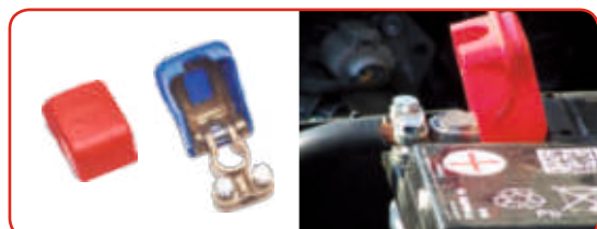
Sistema di chiusura a pressione Locking pressure system Ottone stagnato / Tin plated brass 1000 A - Cavo / Cable 16/50 mm 2 Cod. 40040
