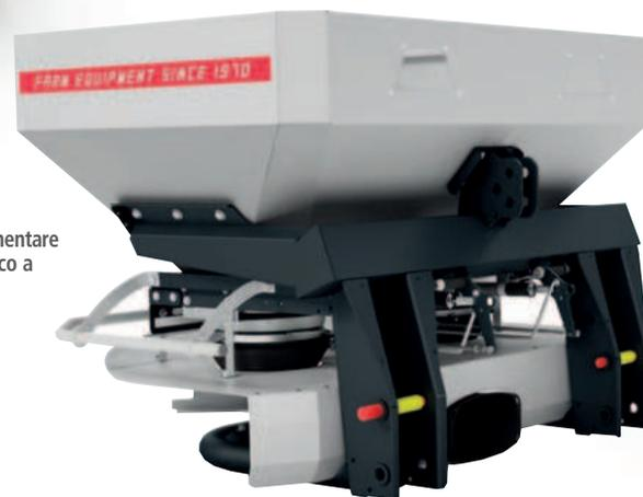
Uno o due rialzi permettono di aumentare la capacità di carico a 1150 o 1500 litri
