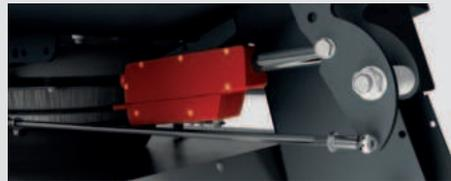
Due **sensori magnetici** rilevano l'esatta apertura di ogni **saracinesca**, comandando i servomotori ed annullando ogni loro possibile errore di posizione.
