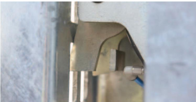
Diese mechanische Sicherheitsverriegelung ist an jeder Ecke der Plattform angebracht und sie sind durch einen
