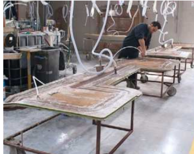
Rivestimenti e arredi dell'ambulanza realizzati in materiale composito, stampati all'interno dello stabilimento con tecnologia RTM Linings and furniture of the ambulance are made of composite material, moulded inside the plant, with RTM technology
