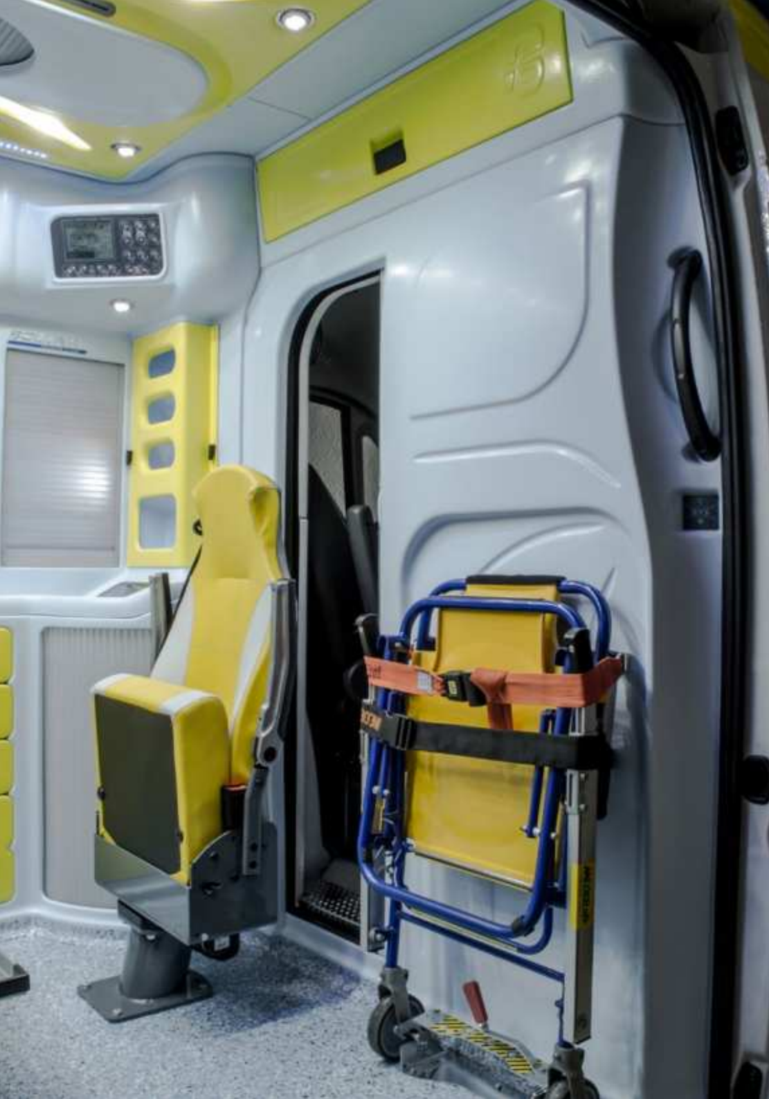
Porta di comunicazione tra ambiente sanitario e lato guida ad azionamento manuale oppure elettrico. Door connecting the health compartment and the driving cab, manually or electric opening
