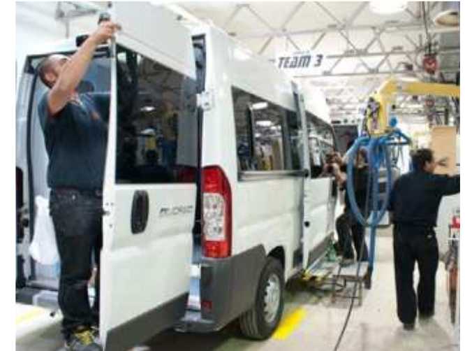
Assemblaggio degli impianti, dei rivestimenti e degli arredi Assembly of systems, linings and furnitures
