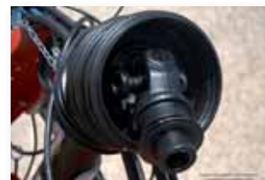
2 transmisiones, la primera con nudo homocinético y embrague de discos a fricción
