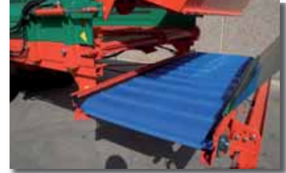
La plataforma de la descarga lateral mediante cinta de goma se desplaza hidráulicamente por medio de cilindro hidráulico, pudiéndose elegir el modo de descarga: trasera o lateral a derecha o izquierda.
