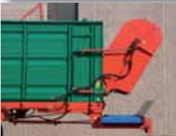
El dosificador de descarga incorpora un sistema de desplazamiento hacia la parte trasera que se acciona durante el proceso de descarga aligerando la presión que el forraje durante el proceso de carga ejerce sobre el mismo y evitando posibles atascos en el momento de arranque de la rotación de las cadenas de distribución del dosificador.
