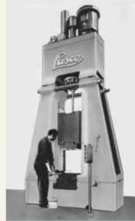
Elektro-ölydraulischer LASCO Gesenschmiedehammer KH/KGK
