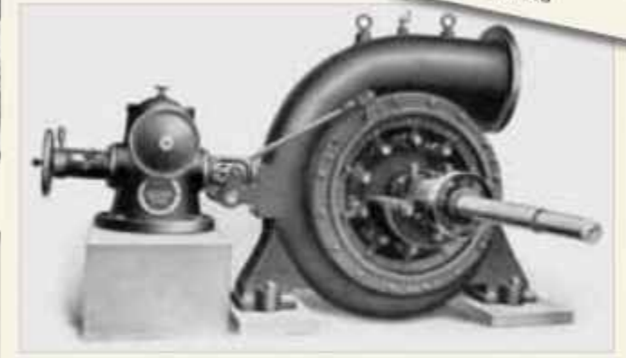
Francis-Spiralturbine mit liegender Welle
