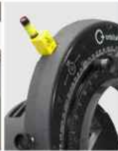
Integrierter Strichlaser zur Trennstellen-Markierung auf dem Rohr
