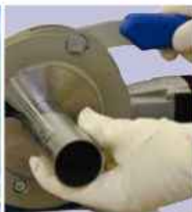
Schnellwechselsystem für Werkzeuge, Spannschalen und Rohre.
