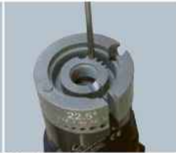
Elektroden spitze anplanen
