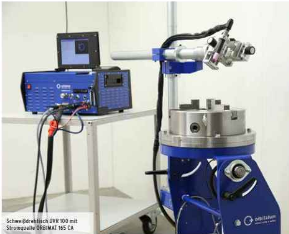
Dreibeckenhalter für ein genaues Positionieren und Fixieren des Werkstücks
