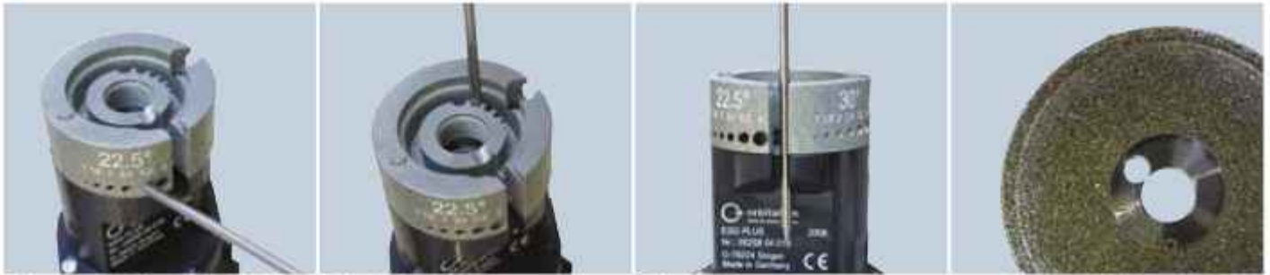
Elektroden anschleifen: 4 unterschiedliche Winkel, 6 unterschiedliche Elektrodendurchmesser
