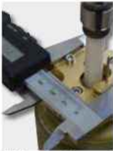
Einfache und präzise Einstellung der Elektrodenposition
