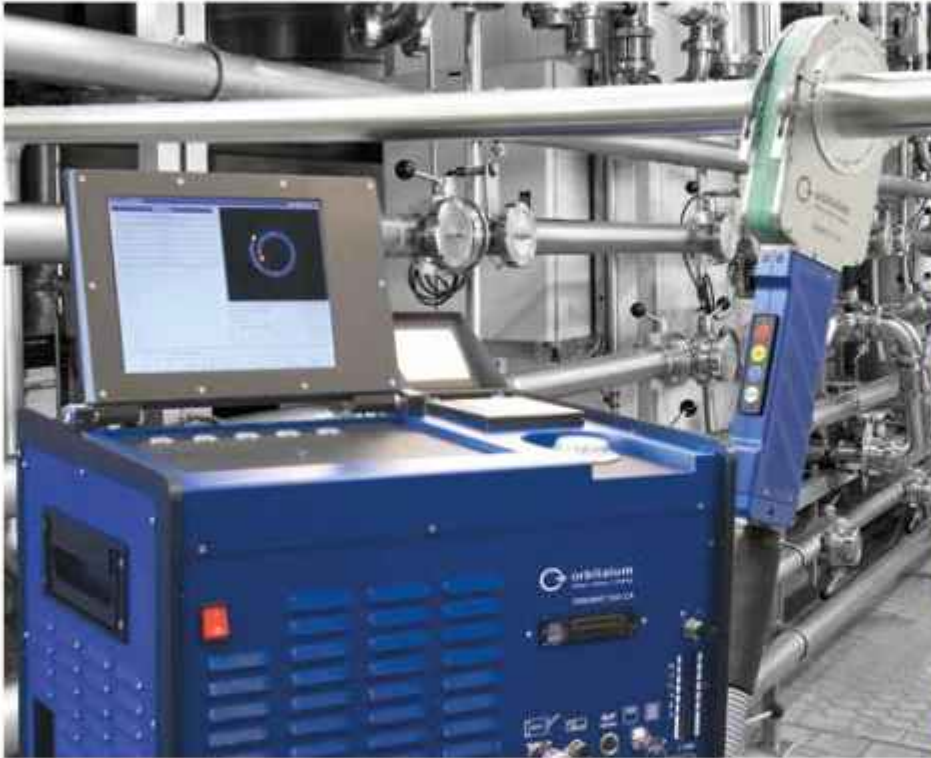
10,5"-Schwenkmonitor und Systemdrucker integriert
