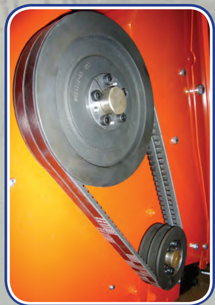
Trasmissione a cinghia dentata Toothed belt transmission Transmission par courroie crantée Zahnriemengetriebe
