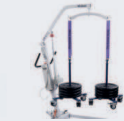
aufgehängter Zustand (Test bei einem 185 kg Lifter)
